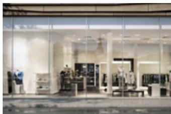
Massima trasparenza grazie alle sezioni in vista ridotte - la nuova generazione di facciata in alluminio a montanti e traversi Schüco FWS 35 PD vanta profili estremamente snelli con una larghezza di soli 35 mm.
