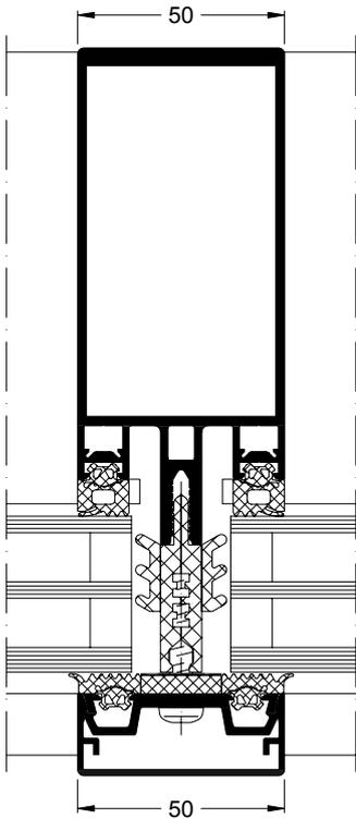
Dettaglio sezione orizzontale della Facciata Schüco FWS 50.SI con sottocopertina in alluminio
